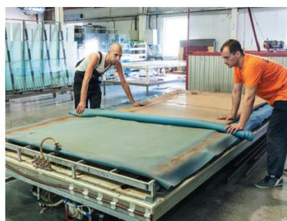
вакуумная электрическая печь для изготовления триплекса
